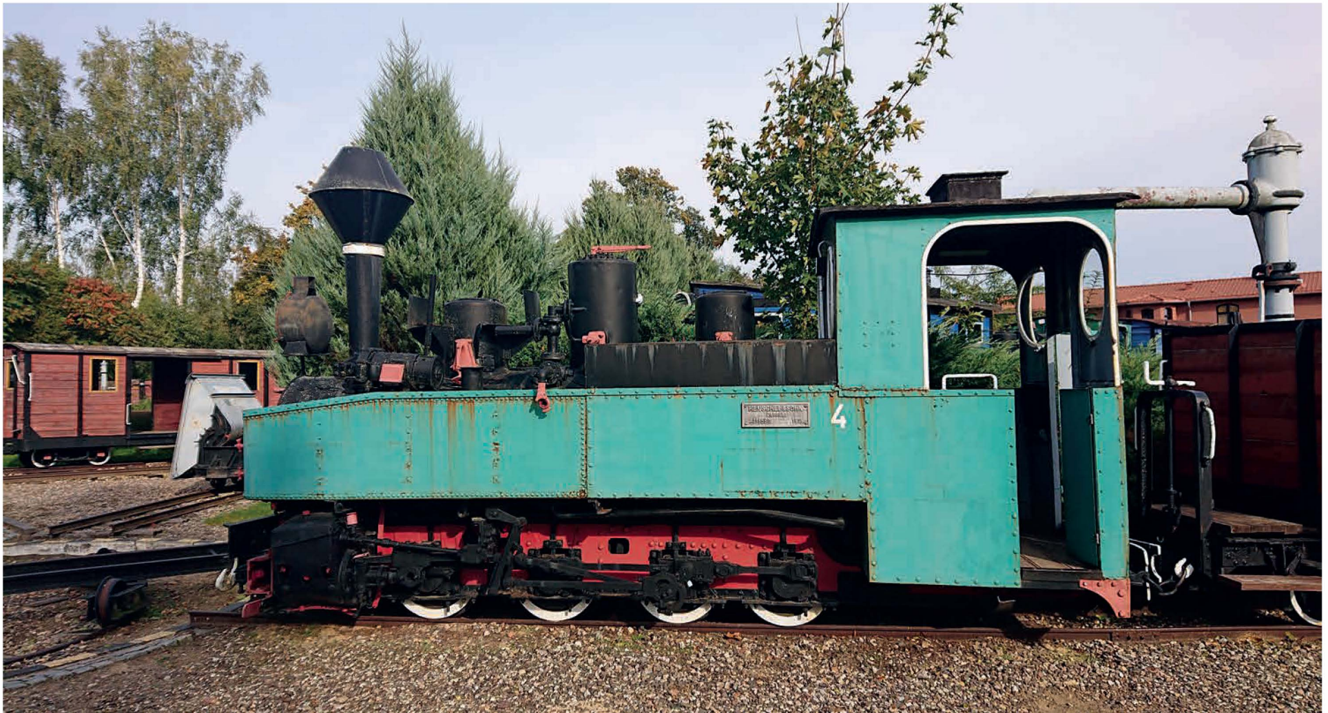
▲ Lokomotywa brygadowa w zbiorach muzeum w Wenecji; od 1905 roku w 15 fabrykach wyprodukowano ponad dwa tysiące sztuk popularnych HF-ek, które dzielnie służyły na kolejach leśnych i cukrowniczych w Europie Wschodniej czasami aż do lat 70. XX wieku.
