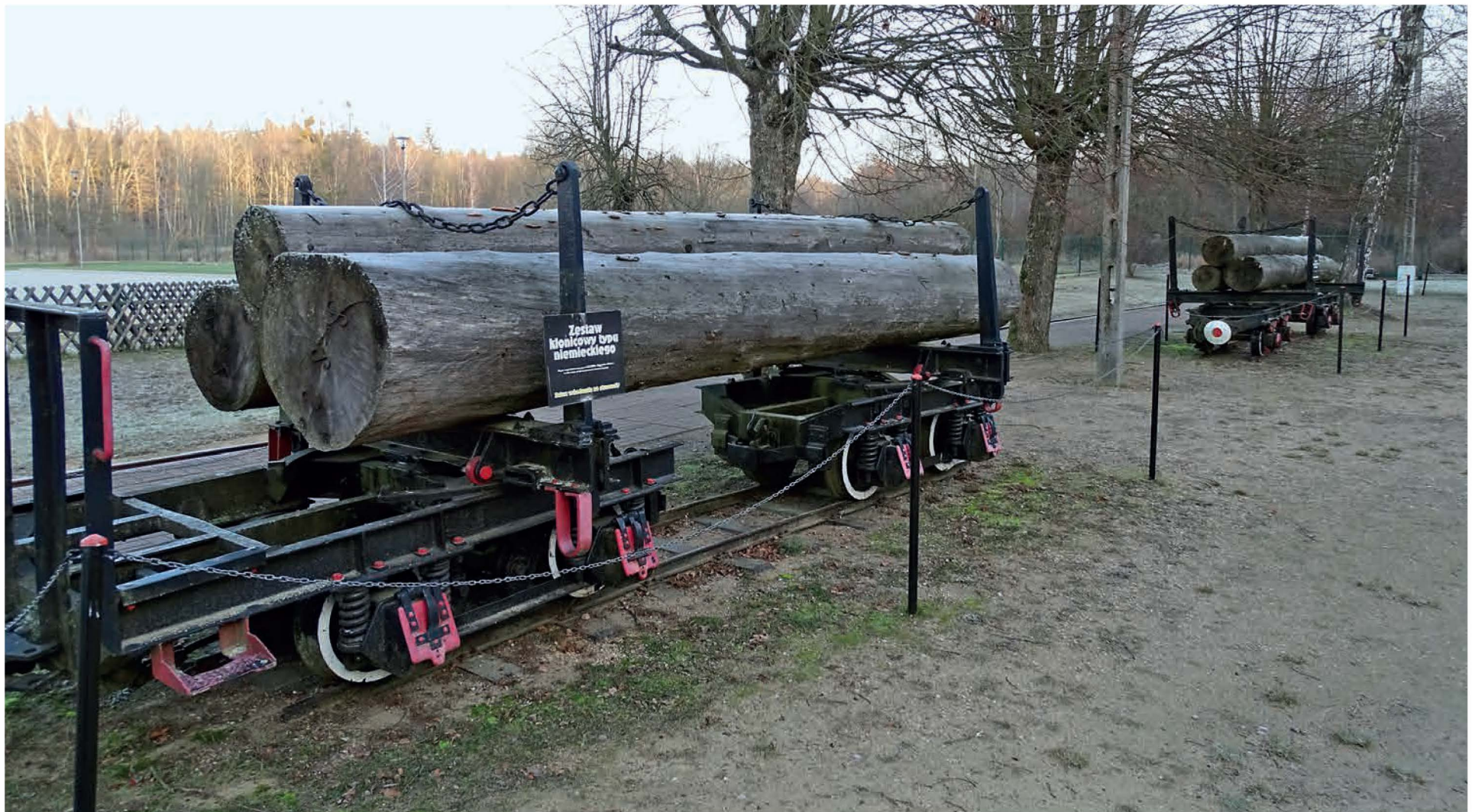
▲ Typowe wagony kłonicowe stosowane na kolejach leśnych do zwozu ściętych drzew w kierunku tartaków; eksploatowane m.in. w Hajnówce
