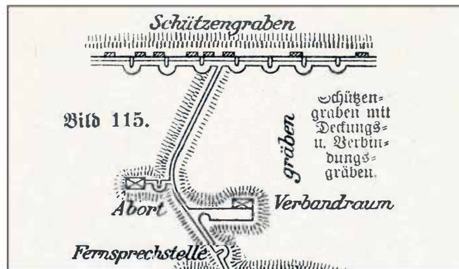
▲ Instrukcja saperska z początku XX w.; rysunek fortyfikacji ziemnych dla piechoty na podstawie którego wykonano umocnienia widoczne na współczesnym obrazie lidarowym bydgoskiego Myśliczka
