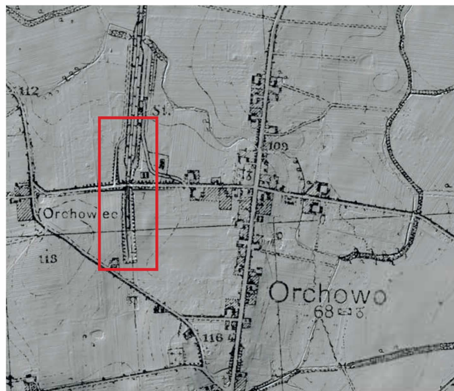
▲ Orchowo na mapie z 1934 roku z naniesionym obrazem lidarowym terenu stacji kolejowej z przygotowanym wykopem pod potencjalną rozbudowę
