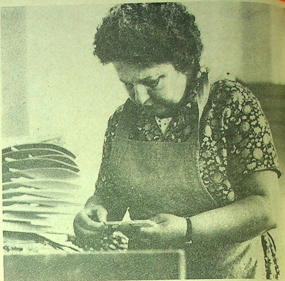
Od przyklejenia belek do płyty górnej w dużej mierze zależy akustyka gitary. Wykonuje to Zofia Kura.
