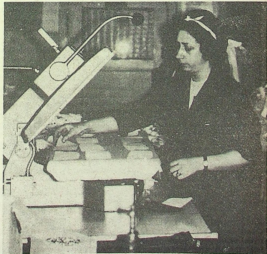
Stefania Rzepecka obsługuje auto matyczną prasę do klejenia wkładów.
