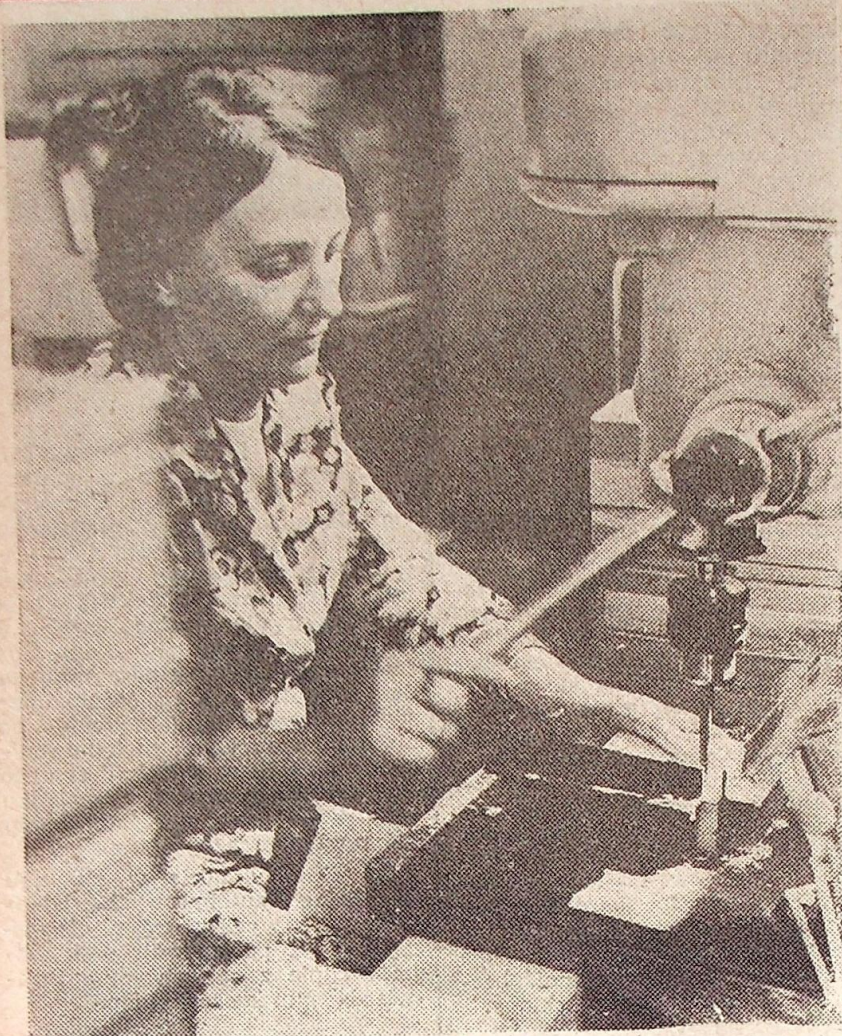
Nawiercanie otworów w pasmanteryjkach wymaga precyzji. Danuta Romaniuk wykonuje tę operację błyskawicznie i dokładnie.
