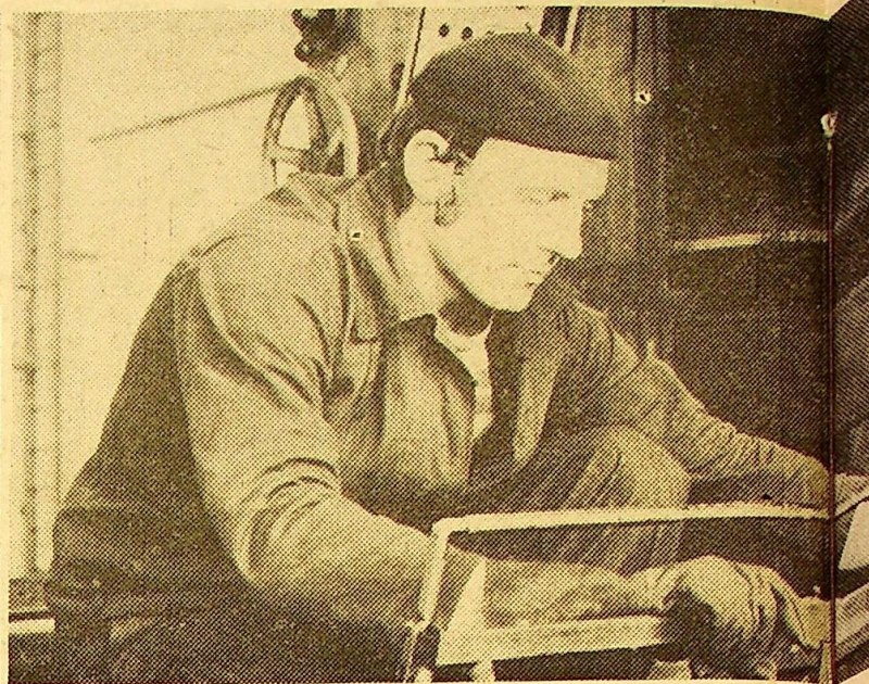
Romuald Grydz jest tokarzem Wydziału Mechanicznego. Zalicza się do zasłużonych pracowników ZMS. Na zdjęciu – dokonuje on pomiaru pierścienia łożyska tocznego, do
