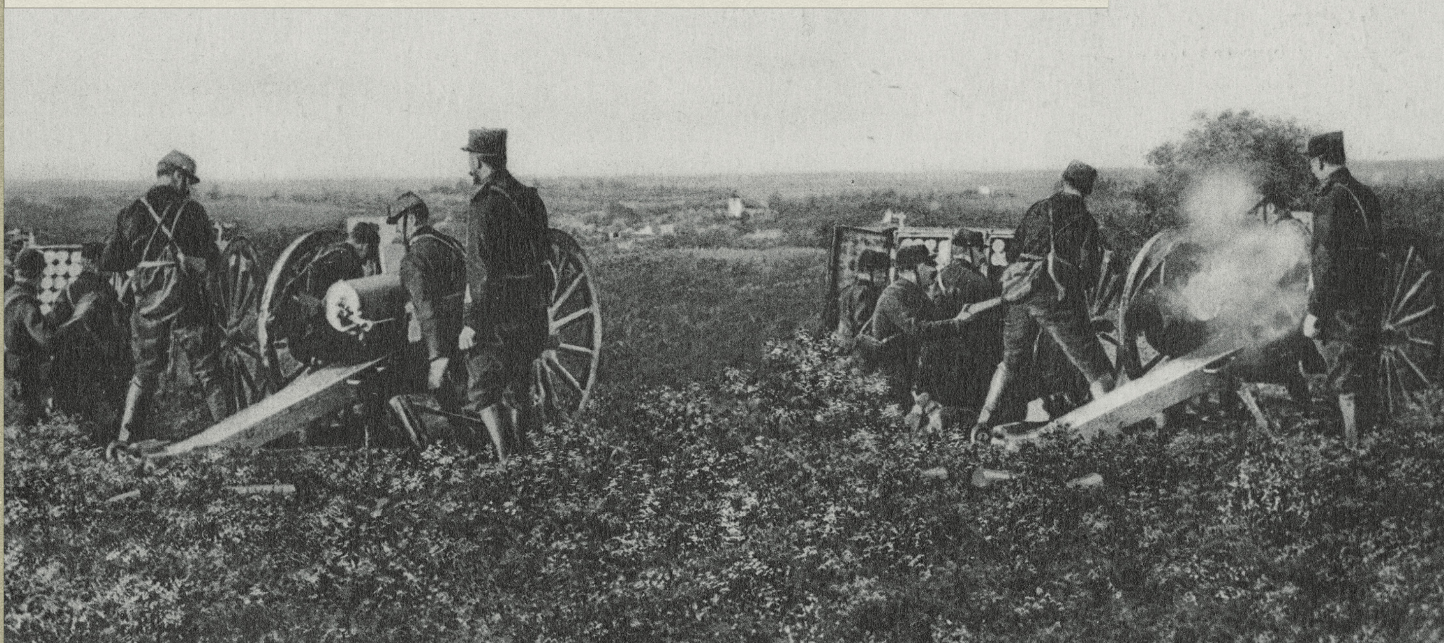
Francuskie armaty polowe 75 mm wz. 1897, wrzesień 1914 roku. Dzięki swojej szybkostrzelności (12 strzałów na minutę) i precyzji prowadzenia ognia, armaty tego typu odegrały kluczową rolę w bitwie nad Marną.
