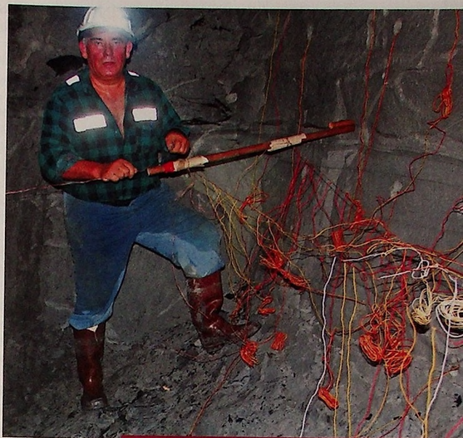
Do 1992 r. ładunki łączono równolegle na „antenkę”.
