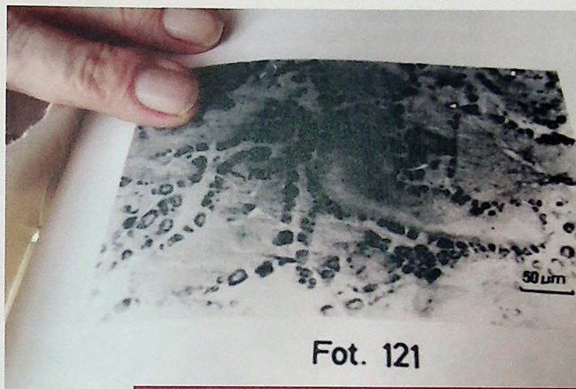
Zdjęcie mikroskopowe łańcuskowatych koncentracji uranitu w thucholicie.
