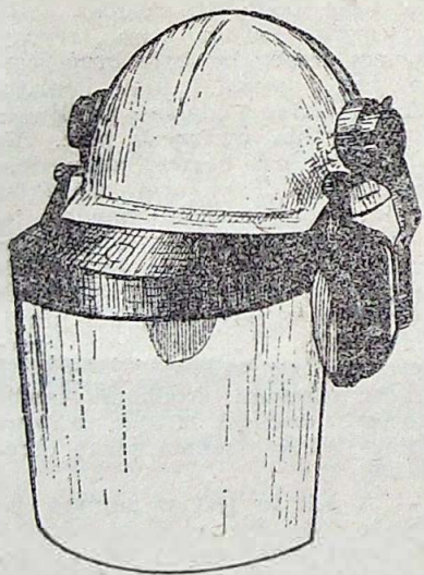
Komplet chroniący głowę, twarz i uszy przed wibracjami, iskrami, kurzem, kroplami cieczy i hałasem.
