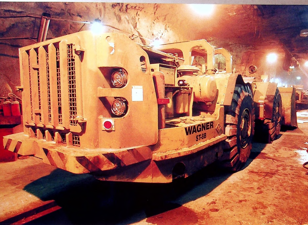
■ Najnowszy typ ładowarek o wysokiej ładowności – Wagner w kopalni „Rudna”
