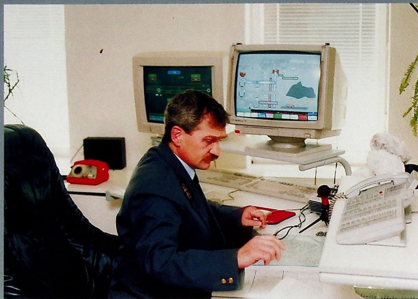
■ Komputerowy system sterowania pracy przenośników taśmowych w kopalni
