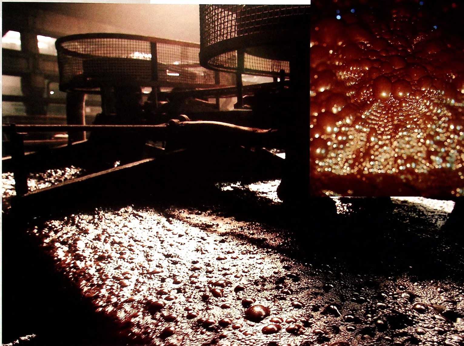
■ Flotacja rudy miedzi; ta pecherzykowata pulpa pozwala odzyskać z rudy minerały miedzi
