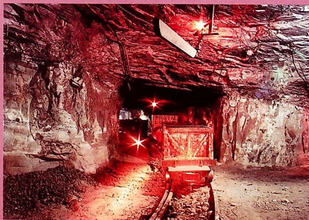
Kontener do przewozu obudowy kotwowej na stacji materiałowej
