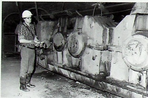
Stacja napędowa przenośnika Legmet-1200 - trasa linowa (na zdjęciu: J. Uniatowicz)
