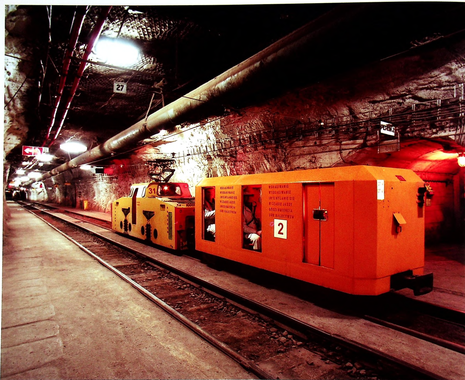
Elektrowóz Ld-31/2 z wozem osobowym WOS-12, na stacji osobowej nr 1 w rejonie LG
