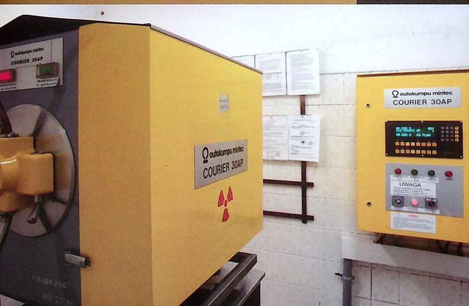
Aparatura do pomiaru zawartości miedzi w produktach przeróbki rudy
