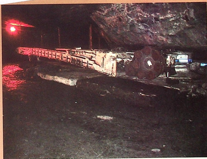
Kombajn ARM 1100 do urabiania bardzo cienkiego złoża
