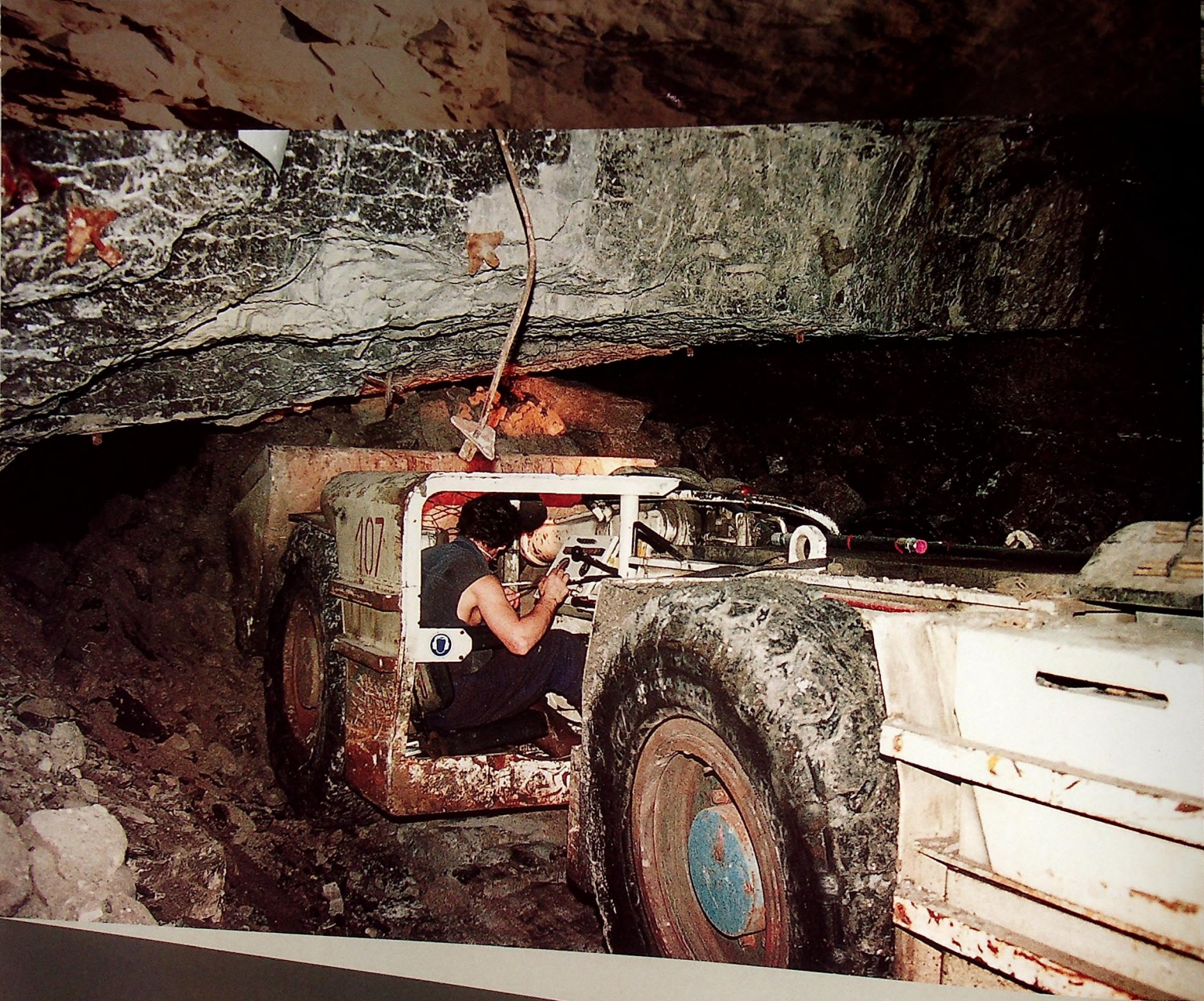
▲ Ładowarka LF-4.2 do bardzo cienkich pokładów
