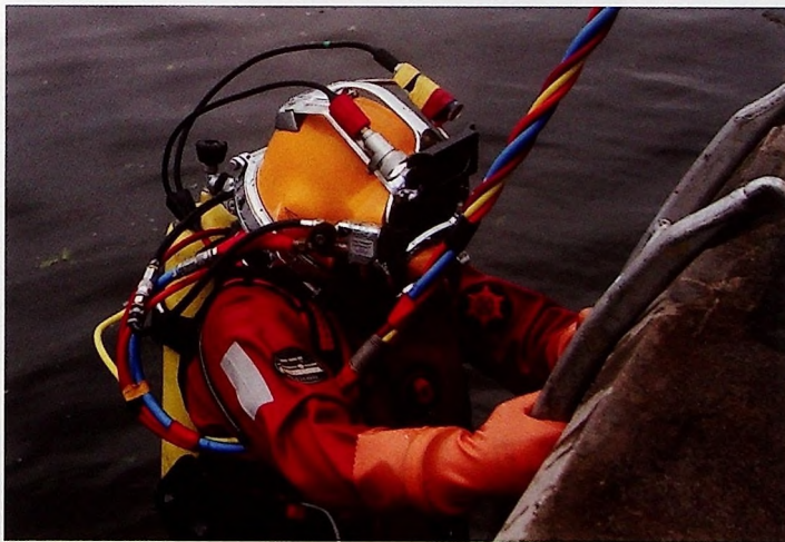
Nurek roboczy w skafandrze suchym. Chelm model 37 firmy Kirby Morgan, połączony za pomocą kabloliny z tablicą nurkową, ma kamerę, oświetlenie i łączność z operatorem tablicy na powierzchni.
