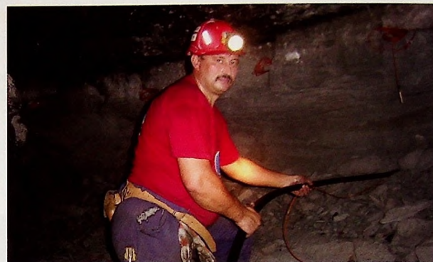
Piotr Worobel górnik strzałowy ładuje otwór strzałowy po raz pierwszy materiałem emulsyjnym luzem
