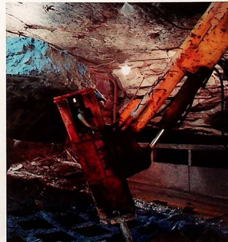
Urządzenie do rozbijania brył URB-k na oddziałowym punkcie wysypowym.
