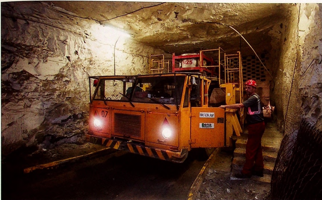
Roman Strycharek operator ruchomego składu materiałów wybuchowych w trakcie umieszczenie platformy ze zbiornikami na matrycę, na stanowisku rozładowniczym.
