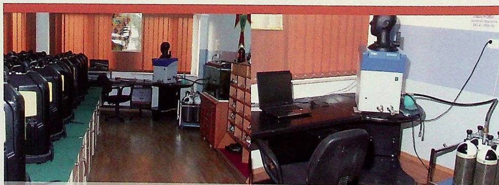
Stanowisko do kontroli masek i aparatów BG4 EP oraz powietrznych aparatów PSS-90
