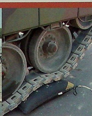
Podnoszenie czołgu za pomocą poduszek
