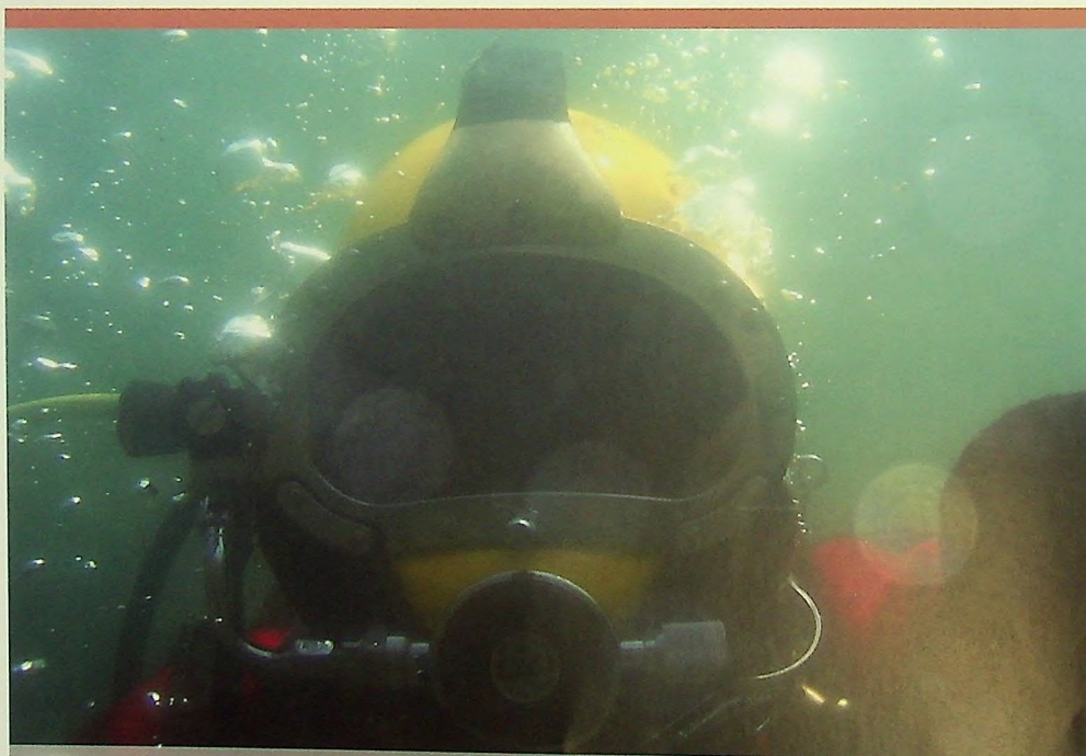
Nowy sprzęt w użyciu. Hełm KIRBY – MORGAN KM 17 Superlight z systemem łączności
